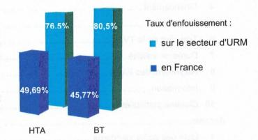
S'agissant de réseaux neufs, URM s'attache à construire plus de 99 % des ouvrages à basse tension en technique souterraine.
